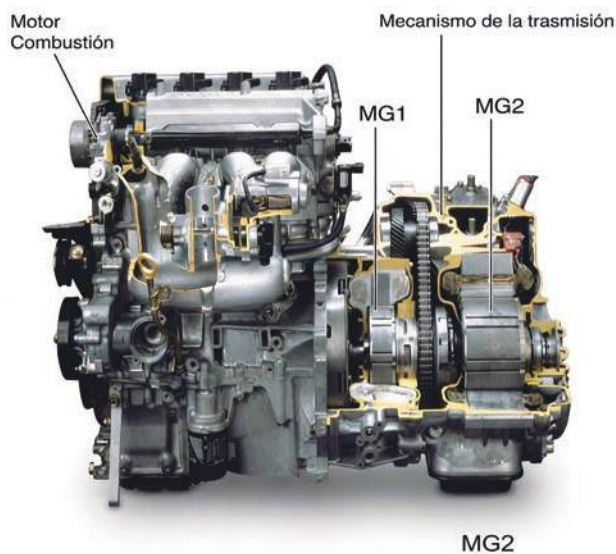
Figura 15. Disposición de los motogeneradores (Toyota)
