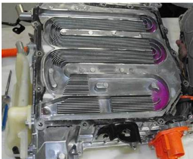
Figura 10. Sistema de refrigeración de un inversor (Alvatronics, 2026)
