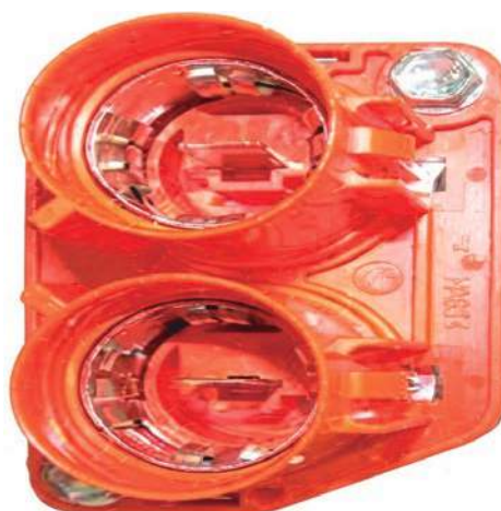
Figura 11. Conector de alta tensión de un inversor (Alvatronics, 2026)
