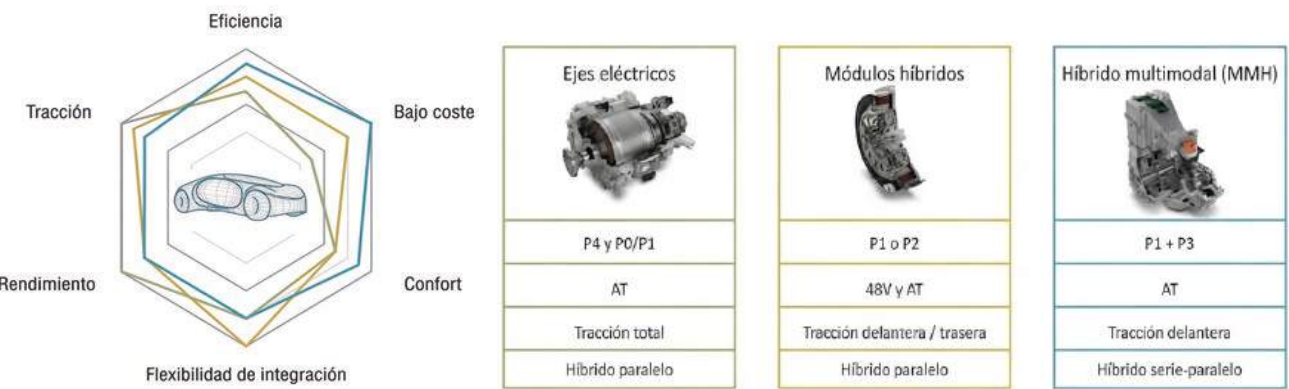
Figura 51. Accionamientos de ejes eléctricos, módulos híbridos y una transmisión híbrida dedicada como sistemas de propulsión para vehículos híbridos (Eckenfels, Fischer, Lehmann, Neuberth, & Reitz, 2022)
