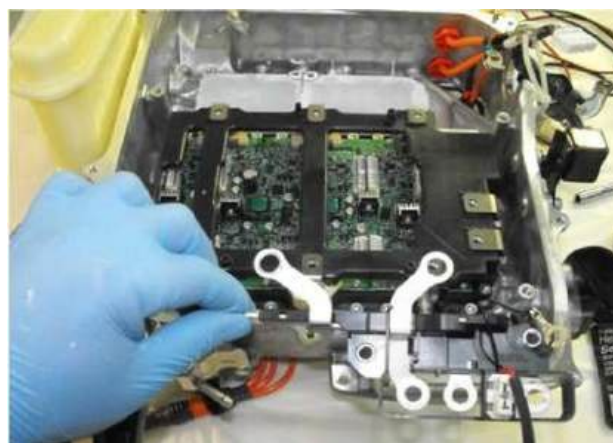
Figura 9. Vista interior de un inversor (Alvatronics, 2026)
