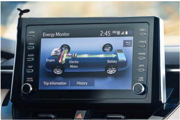
Figura 126. Pantalla de flujo de energía (Alvatronics, 2026)
