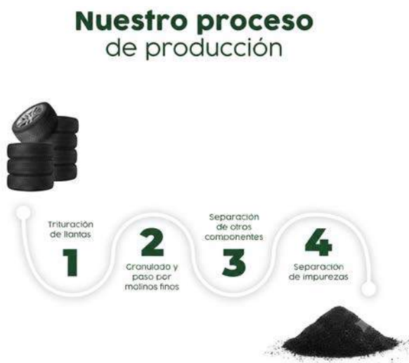
Figura 27: Etapas de recuperación de granulo de caucho
